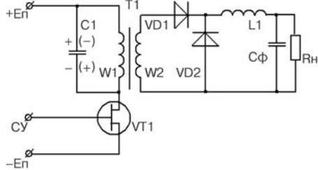
Рис. 1. Классическая схема ОПП
